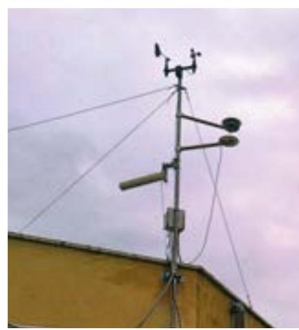
**Figura 15 – Stazione di acquisizione dati solari e stazione meteo (Utrinn-Pci)**
